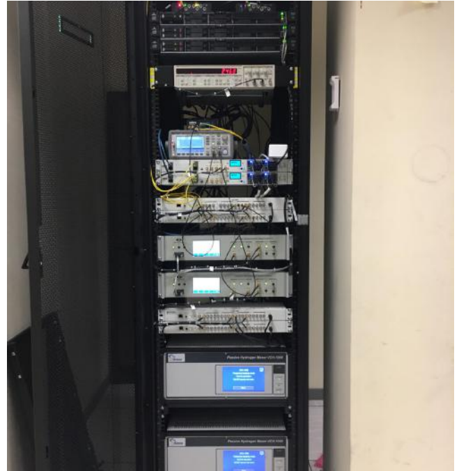
Dispositivos creados por Seven Solutions para la distribución de frecuencia y la transferencia de tiempo ultra precisa y determinística.
